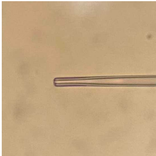
丸くしたガラスピペット先端
