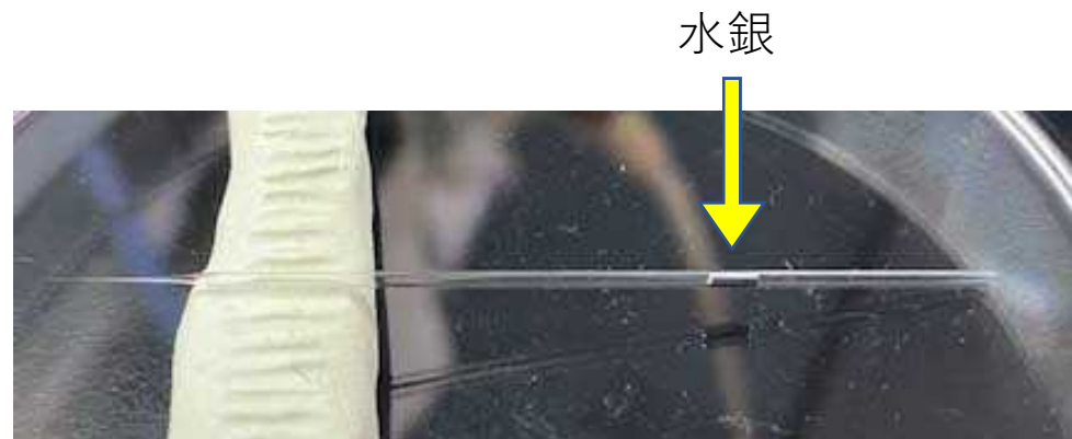
水銀を充填したガラスピペット
